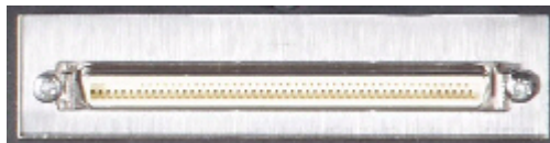
Figure A-8: ADC edge socket
